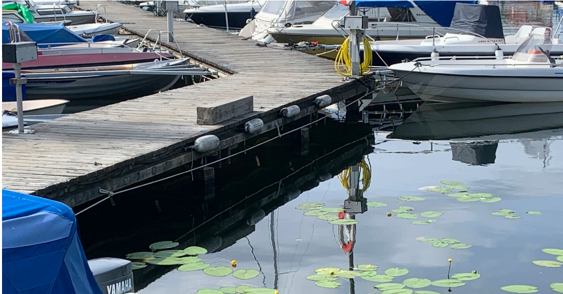
Bild 2:47 Om någon trillar i vattnet kan det vara svårt att nå upp till bryggkant eller båtar. En lina att hålla sig i gör det lättare att ta sig till närmaste räddningsstege, eller in till grunt vatten. Foto: Jimmy Dominius.
