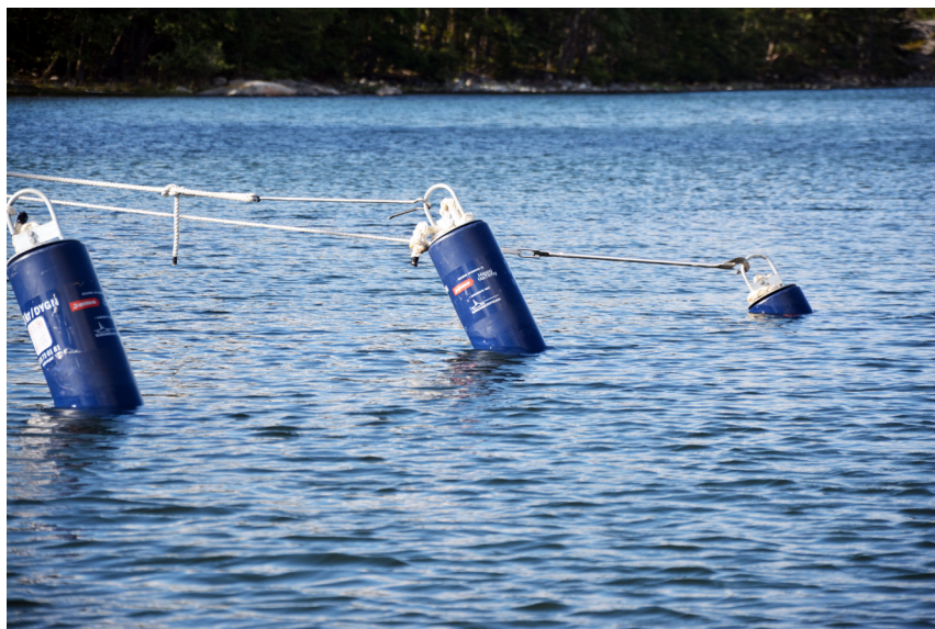
Bild 2:21 Pålbojar med sträckt förankring påverkar växtligheten på botten mindre än bojar med löst hängande kätting. Kan användas för svajförtöjning eller vid förtöjning mot brygga. Foto: Martin Gadman, Skärgårdsstiftelsen.
