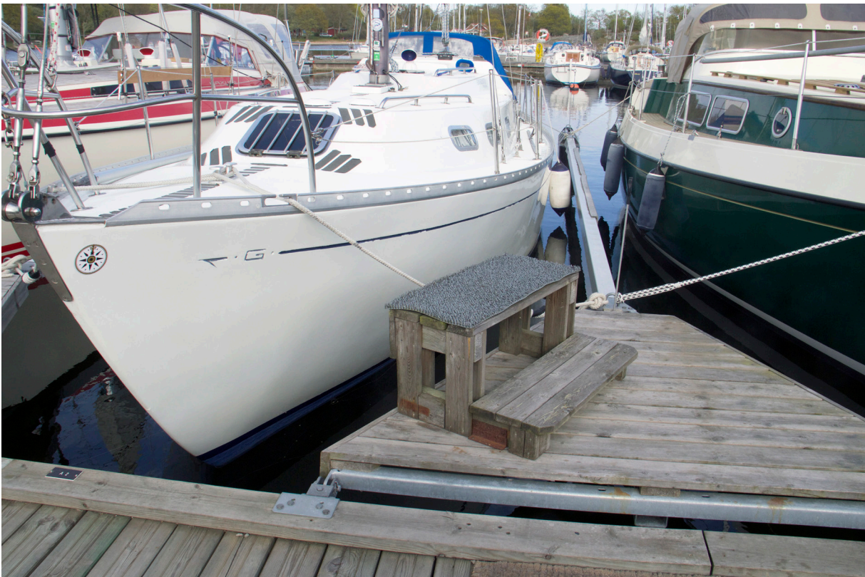
Bild 2:51 Att gå ombord över stäven kan vara både svårt och farligt, särskilt om pulpit och förstug inte är anpassade för tilläggning med fören mot bryggan. En enkel trappa på bryggan/bommen höjer säkerheten och komforten. Foto: Jonas Ekblad.
