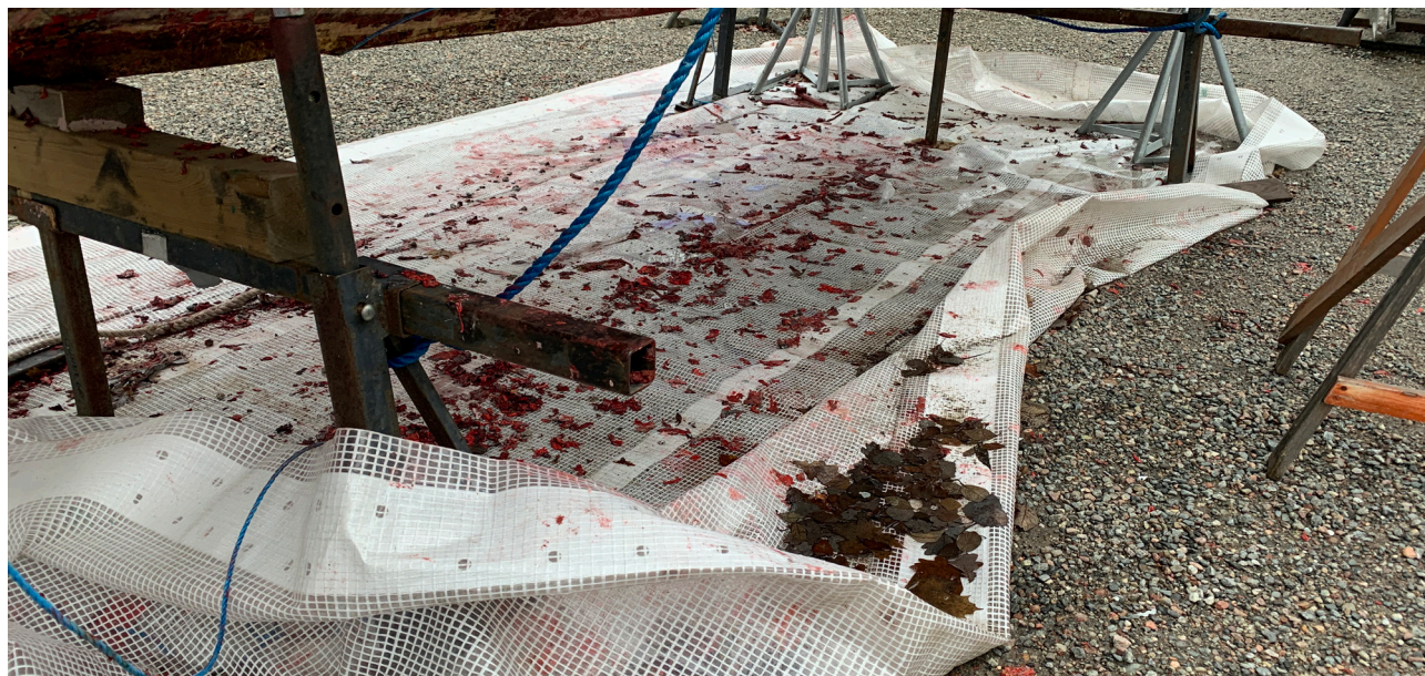
Bild 9:5 Vid skrapning/slipning av båtens botten är det viktigt att se till att inga skraprester/slipdamm kommer på marken eller till luften. Det är bra att täcka marken, men så här får det absolut inte se ut – minsta vindpust så hamnar damm och skraprester på marken. Foto: Jimmy Dominus.
