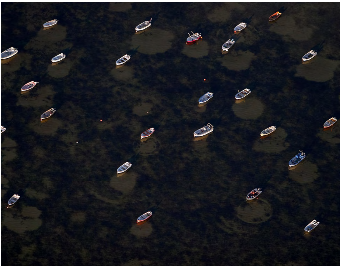
Bild 2:37 Släpande kättingar från ankare eller boj kan riva upp vegetation på botten och orsaka stora skador. På bilden syns så kallade "Dead Spots" eller Döda Cirklar. Bild: Seaflex AB.
