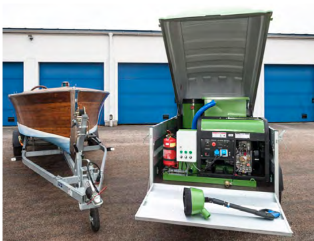
Bild 4:2 Mobil båtbottentvätt. Foto: Ekowasher AB.
