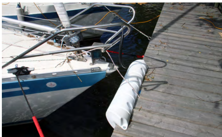
Bild 2:43 Med en rejäl fendert som är fast monterad på bryggan blir det lättare att lägga till. Då kan båten ligga förtöjd nära bryggan vilket gör det enklare och säkrare att stiga iland och ombord. Foto: Jonas Ekblad.
