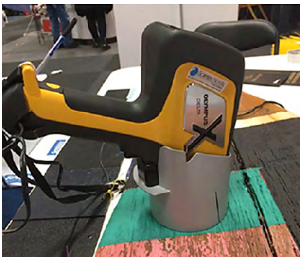
Bild 9:7 XRF-instrument för mätning av giftiga metaller på båtbottnen eller i marken. Foto: Jimmy Dominus.
