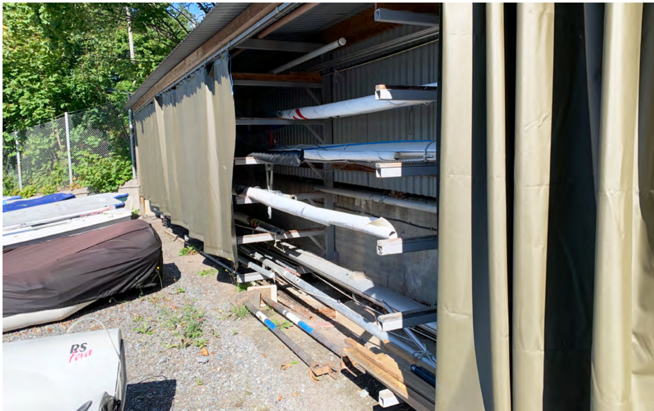
Bild 4.7 Exempel på ett enklare mastskjul med gardin för väderskydd. Ett sådant mastställ kan också användas för kanoter/kajaker under sommaren. Foto: Jimmy Dominus.
