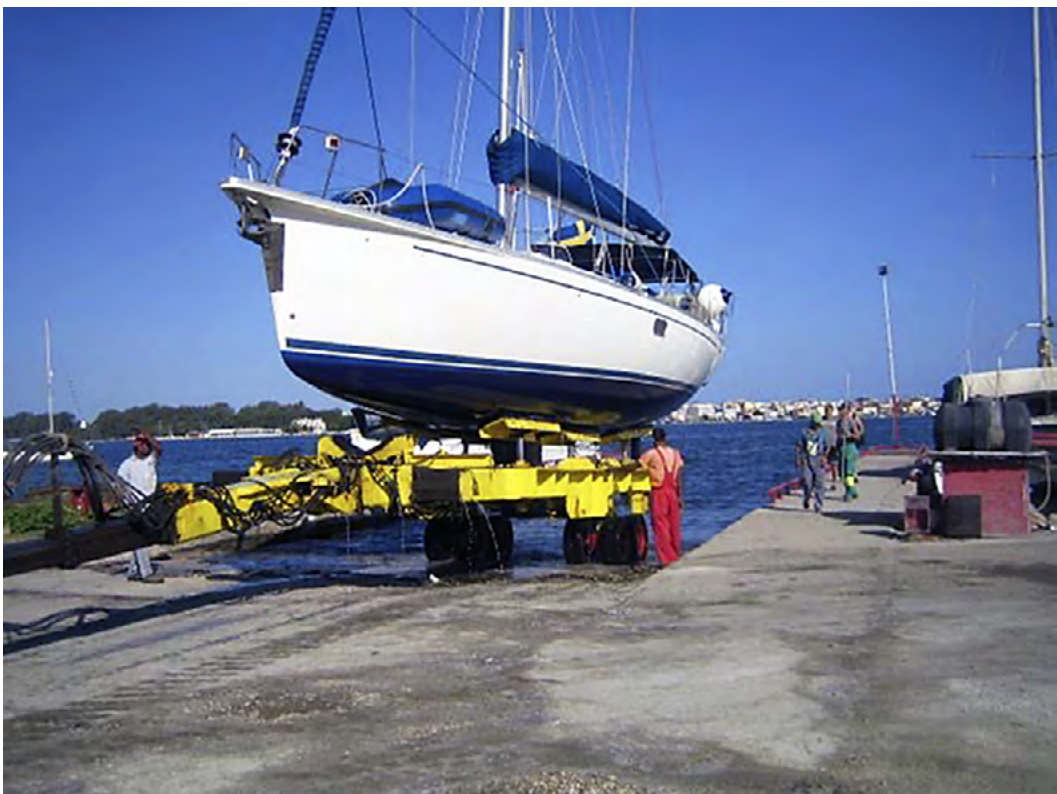
Bild 3:12 Upptagning med hydraulvagn kopplad till traktor.
